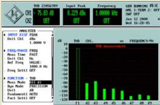
Bild 2: Bei der THD-Messung können alle, einzelne oder beliebige Kombinationen von Harmonischen gemessen werden
