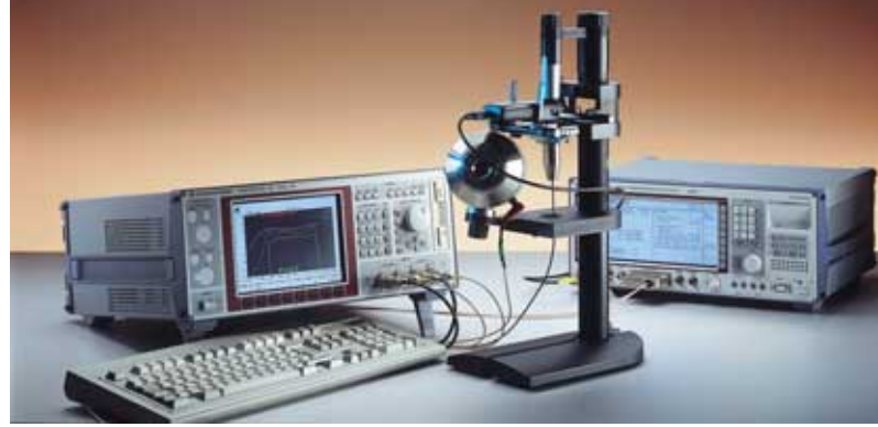
Akustische Messung an GSM-Mobiltelefonen mit Audio-Analysator R&S UPL 16
