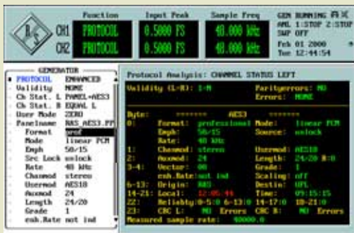
Bild 12: Die Generierung und Analyse der Zusatzdaten im digitalen Datenstrom ermöglicht der R&S UPL in allen üblichen Standards; die Darstellung erfolgt binär, als Hex-Zahlen, im ASCII-Format oder ausgewertet im Consumer- oder Professional-Format
